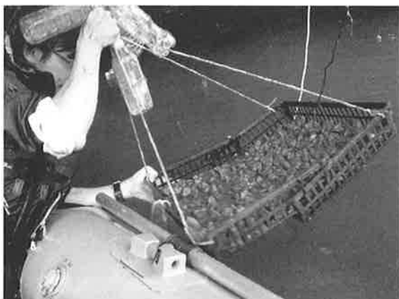
写真7 手作りの人工産卵床の底面にリサイクルガラス製防犯砂利を貼り付け、天然砂利で浮力バランスをとった吊り下げ式人工産卵床。四隅に500ccのペットボトルを結わえ、中央で束ねている。ゴムボートで見回り中。
