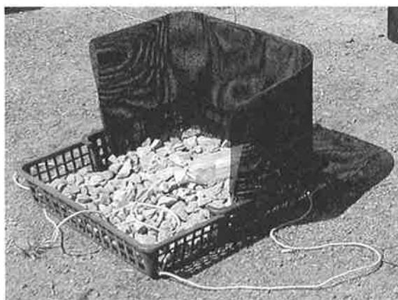
写真1 伊豆沼式人工産卵床。苗ポット用トレーの1辺を切って2つ重ねてほぼ正方形の底面を作り、細目メッシュの上に砂利を敷き、3方を衝立てで囲む。左右に付いたロープは運搬および引き上げ用で、目印としてペットボトル等を結わえる。
