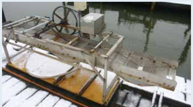
シジミ選別機（漁獲したシジミをサイズごとに選別する機械）
